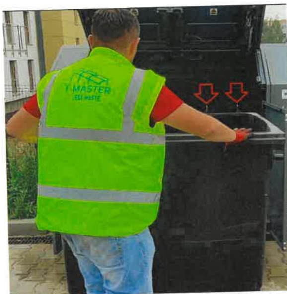
Nieprawidłowe wstawienie kosza do modułu T-Master DROP&GO
