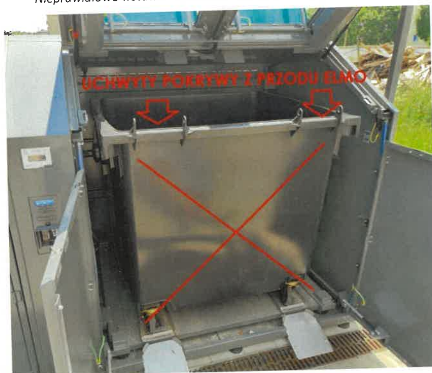
Nieprawidłowe wstawienie kosza do modułu T-Master DROP&GO
